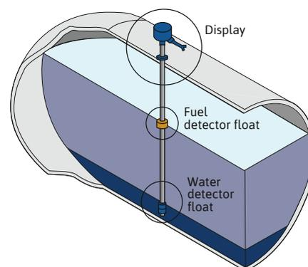
ES-LEVEL è un innovativo indicatore di livello multifunzionale ad alta precisione che consente di monitorare e controllare il livello di liquido nei serbatoi.
